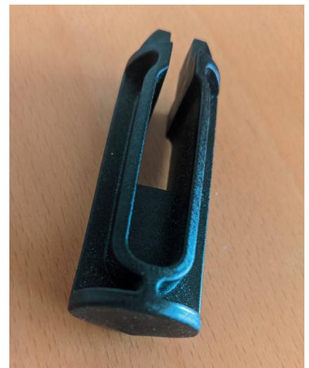
**Bild 2.** Das Bauteil wird im Lackierprozess eingesetzt, um die Motorhaube auf einen definierten Abstand zu halten © Eisenhuth
